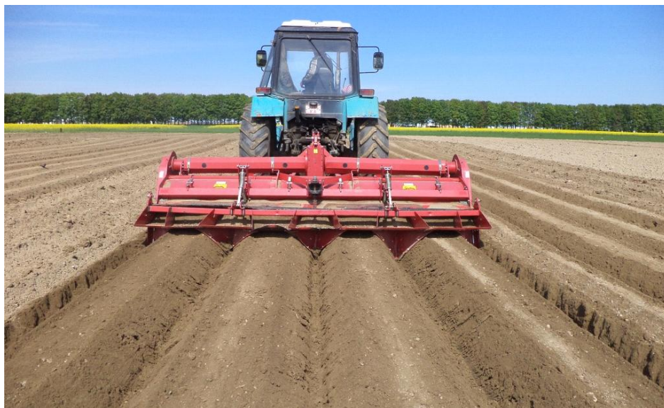
Рисунок 1 – Формирование объемных гребней после посадки картофеля АМК-4-90 с междурядьями 90 см на поле агротехнического севооборота РУП «Научно-практический центр Национальной академии наук Беларуси по картофелеводству и плодоовощеводству», 2015 г.
