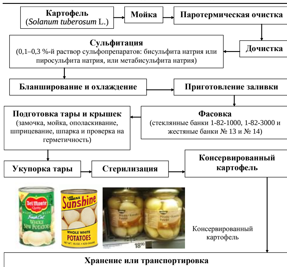
Рисунок – Технологическая процессуальная схема производства консервированного картофеля
