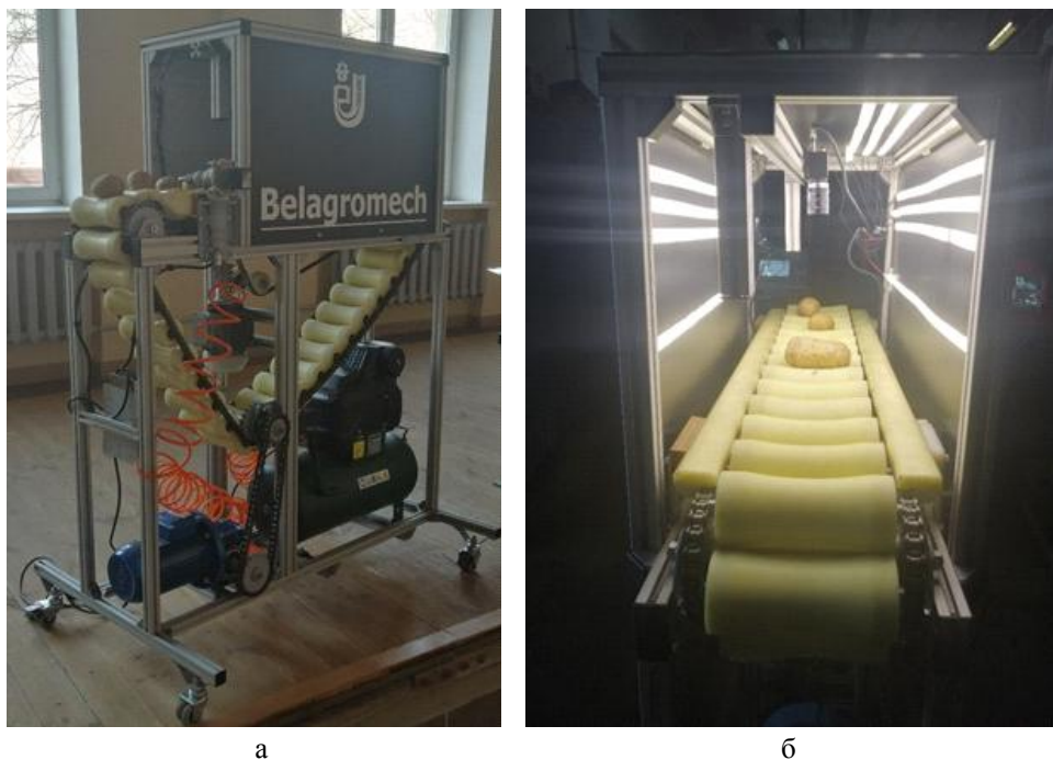
Рисунок 1 – Макетный образец идентификации и отделения некондиционных клубней картофеля: а – внешний вид; б – зона распознавания
