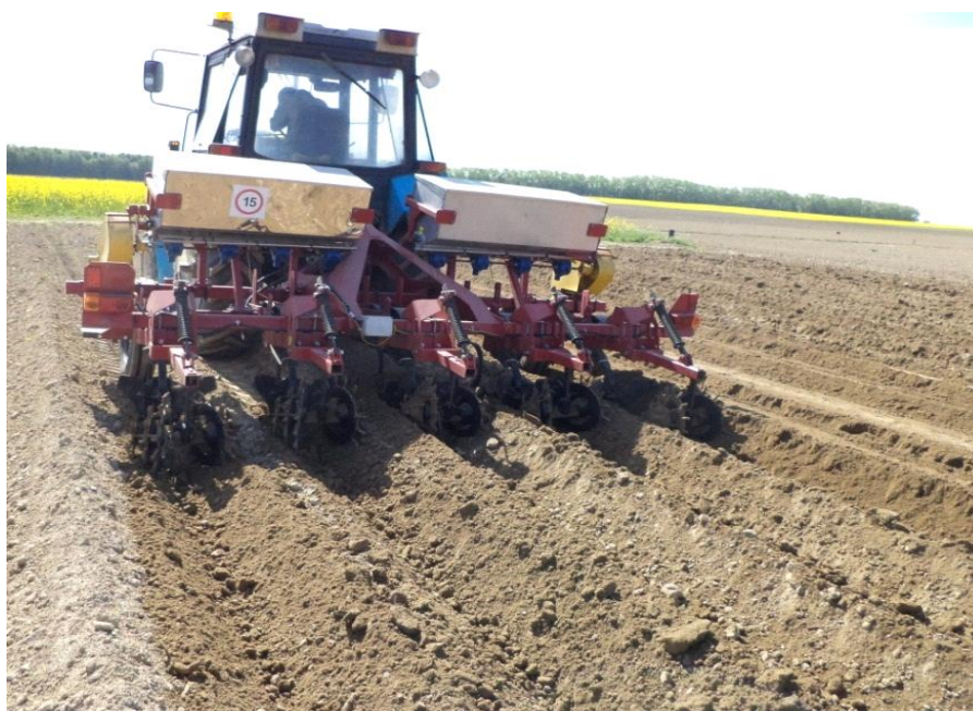
Рисунок 2 – Формирование гребней после посадки картофеля КОР-4 с междурядьями 70 см на поле агротехнического севооборота РУП «Научно-практический центр Национальной академии наук Беларуси по картофелеводству и плодоовощеводству», 2016 г.
