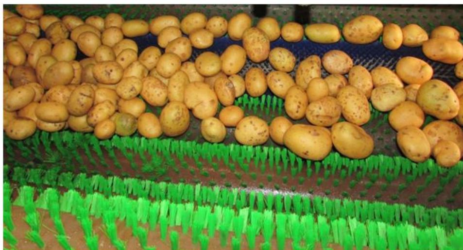
Рисунок 3 – Мойка с ополаскиванием клубней картофеля в машине моечной щеточного типа Ш12-МШТ
