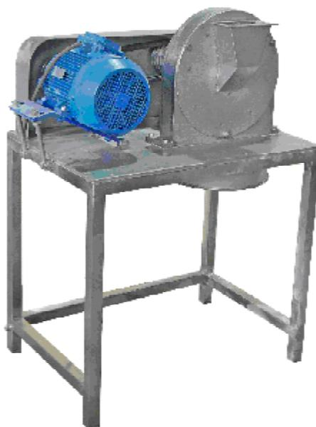
Рисунок 3 – Общий вид измельчителя Ш12-ДКХ
