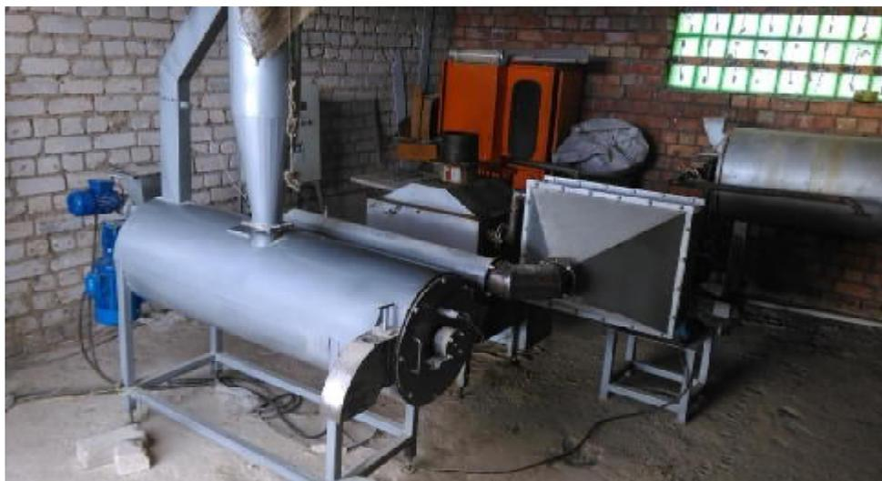
Рисунок 7 – Установка сушильная экспериментальная Ш12-УСЭ
