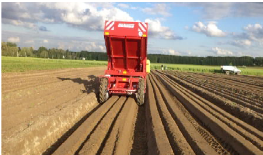
Рисунок 1 – Посадка картофеля картофелесажалкой GB-330 на грядках в 2 строки с междурядьем 84 см (42 + 42 см) и 3 строки с междурядьями 42 см (42 + 42 + 42 см) в РУП «Научно-практический центр НАН Беларуси по картофелеводству и плодоовощеводству» (аг. Самохваловичи), 2014 г.
